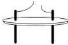
**Fig. 38 Blown Filament**
