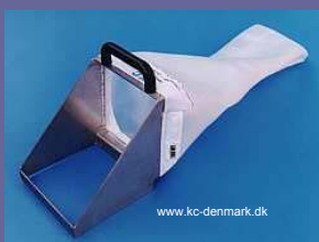
1. attēls Surbera tipa paraugu ņemšanas ierīce
