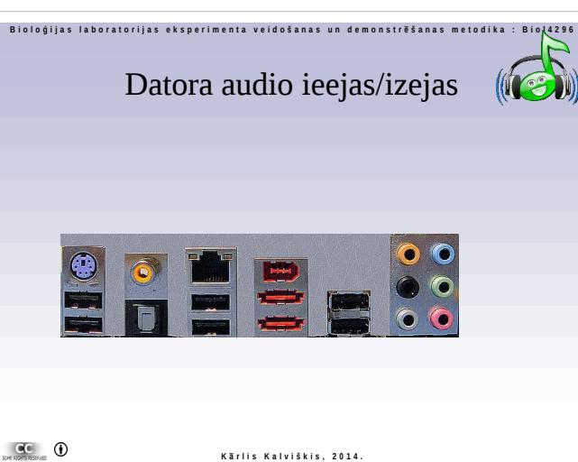
Portatīvajos datoros S/PDIF var būt apvienots ar analogo izeju. Daļai datoru analogo audio signālu ieejas/izejas iespējams programmatiski izmainīt to funkcijas, piemēram, iespējams uztaisīt, ka ka visas sešas ir izejas.
