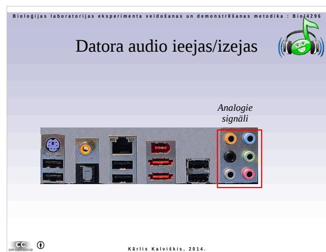
Portatīvajos datoros S/PDIF var būt apvienots ar analogo izeju. Daļai datoru analogo audio signālu ieejas/izejas iespējams programmatiski izmainīt to funkcijas, piemēram, iespējams uztaisīt, ka ka visas sešas ir izejas.
