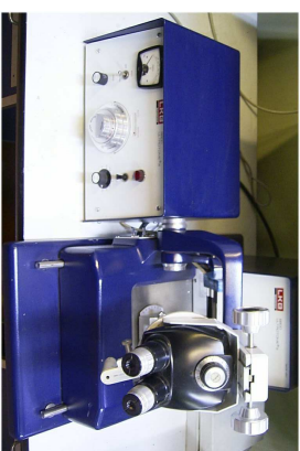
Ultramikrotoms. Griezumna biezums 100 nm.
